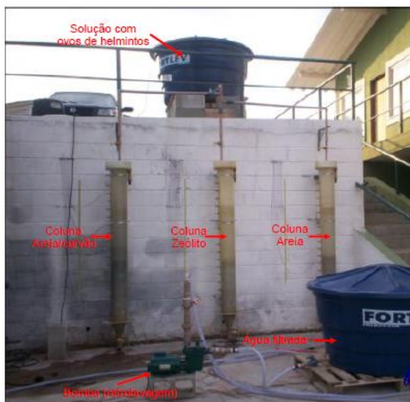
Figura 4 - Foto do sistema de filtração à gravidade com três colunas de filtração (areia/carvão, zeólita e areia), um reservatório para alimentação e outro para o filtrado
